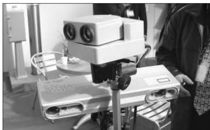
Le operazioni di taratura di un rilevatore elettronico di velocità
